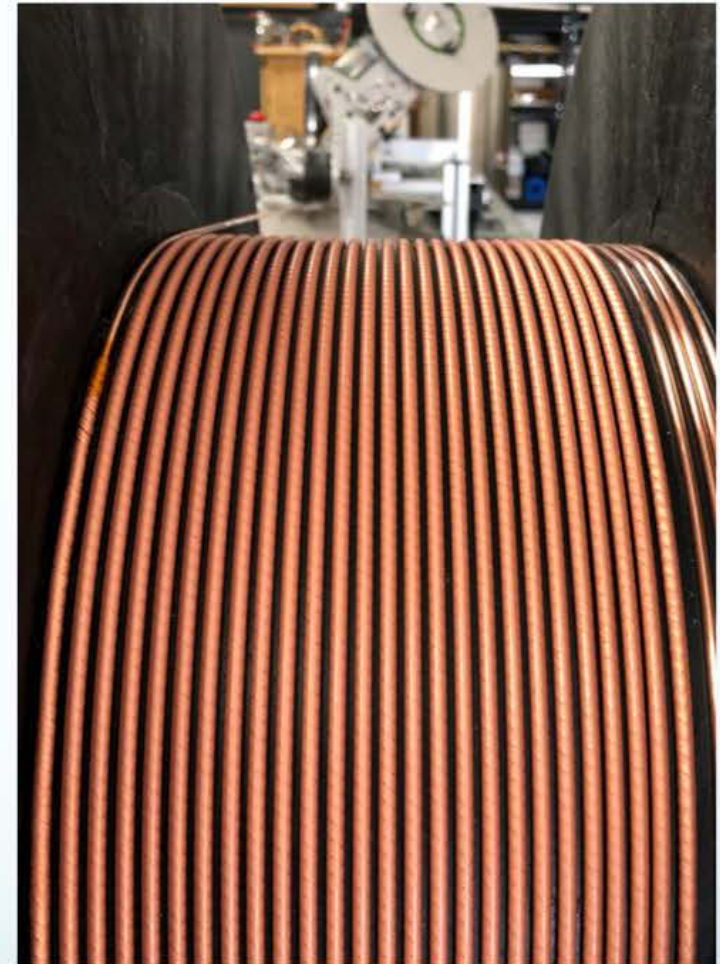
28 meter CORC ® wire
